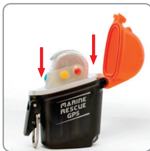
Desserrez les deux vis sur le capuchon supérieur
