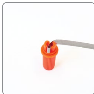
如需卷起天线,请使用盒中工具。将天线尾部穿过卷线器孔。
